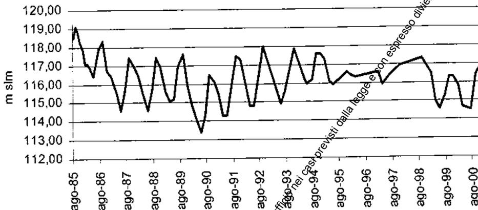
Figura 1: Oscillazione piezometrica del pozzo pubblico a scopo idropotabile - Castenedolo 1
